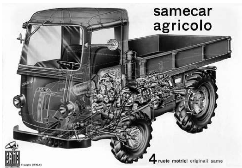
7. Disegno tecnico del Samecar agricolo: vista prospettica e spaccato, 1965
